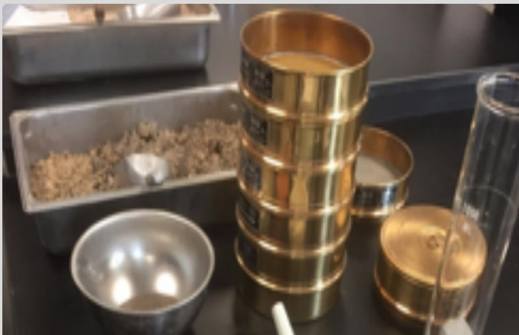
**Figura 04: Ensaio em laboratório de de materiais granulosos – insumos para o concreto. Disponível em: <https://www.guiadaengenharia.com/analise-granulometrica-solo/>**
